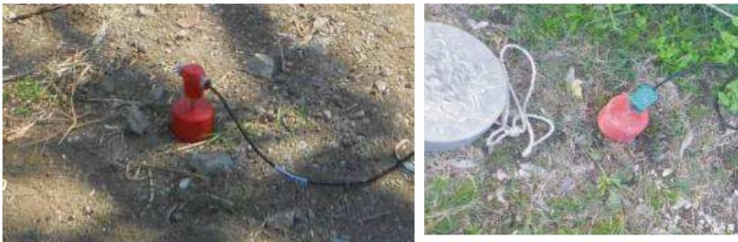
Figura 3 – Particolare del sensore ed accoppiamento col terreno e sistema energizzante.
